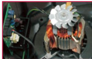
Sistema de controlo electrónico integrado, monitoriza a voltagem, a temperatura do motor e dispõe de uma função de arranque suave, fazendo com que a vida útil do aspirador se prolongue.
