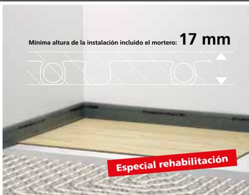
Mínima altura de la instalación incluido el mortero: **17 mm**
